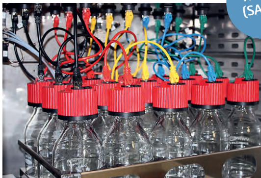
System zur Bewertung des Biogaspotenzials mit integrierter Gasanalytik
