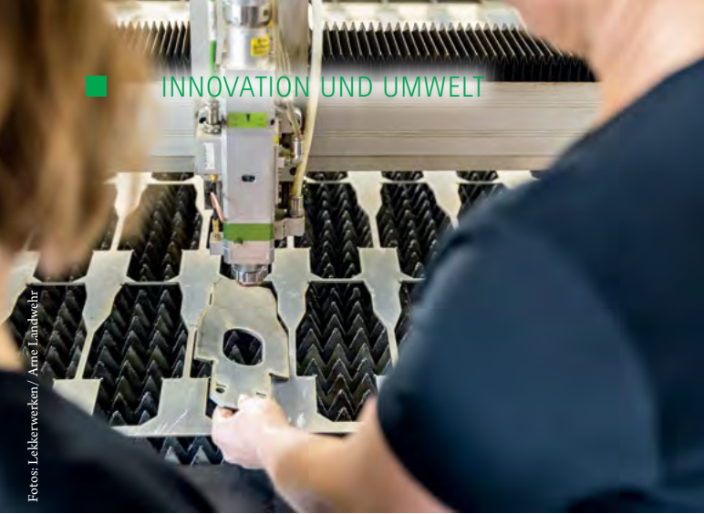
Einfache Übernahme von Kundendaten, präziser Schnitt, weniger Staub: der digital gesteuerte Faserlaser.
