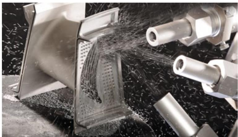
lung des Kunden – die Oberflächengüte des Werkstücks verändert. Die Schleifkörper sind zwischen 1 mm und 80 mm groß, wobei kleine Schleifkörper auch in kleinste Bohrungen und Nuten einwirken können. Wir sind das einzige Unternehmen, das Maschinen, Schleifkörper und Compounds aus einer Hand anbietet. Unser Sortiment an 15.000 unterschiedlichen Schleifkörpern und Compounds unterstreicht, dass wir mit unserem Know-How in der Gleitschlifftechnik führend sind.
