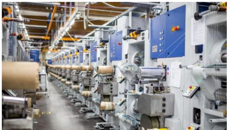
Glasfasern benötigt, die man für die Herstellung von Rotorblättern für Windräder verwendet. Glasfasern bieten die erforderliche Stabilität bei relativ geringem Gewicht. Auch die Herstellung von Kunstrasen wäre ohne Maschinen von Dietze + Schell nicht denkbar. Hier wickeln und texturieren unsere Spulmaschinen die Monofilamente, die zuvor auf Extrusionsanlagen – meist ebenfalls aus der Unternehmensgruppe geliefert – produziert wurden.
