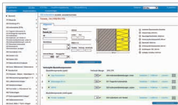
Mit eLCA modellierter Außenwandaufbau
