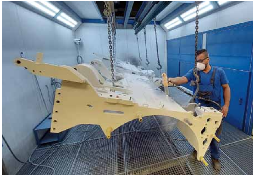
Pulverbeschichtungsanlage der BAF GmbH in Leubsdorf.
