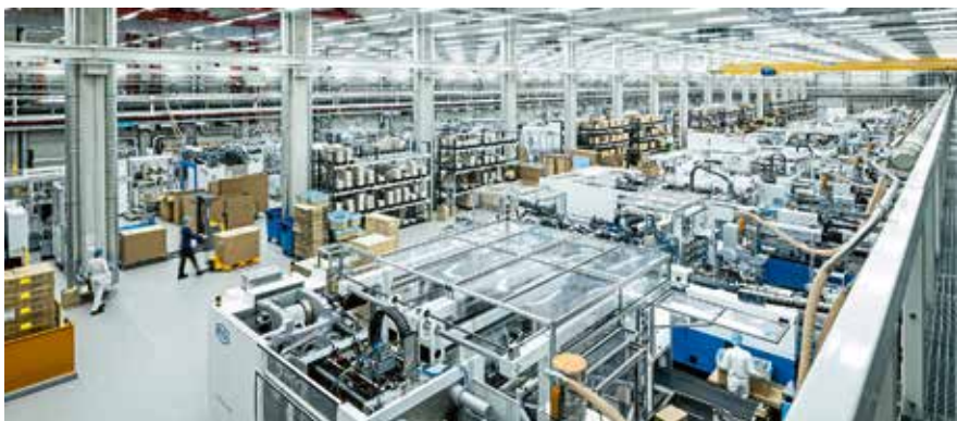
Hochmoderner Maschinenpark mit mehr als 130 Spritzgussmaschinen.
