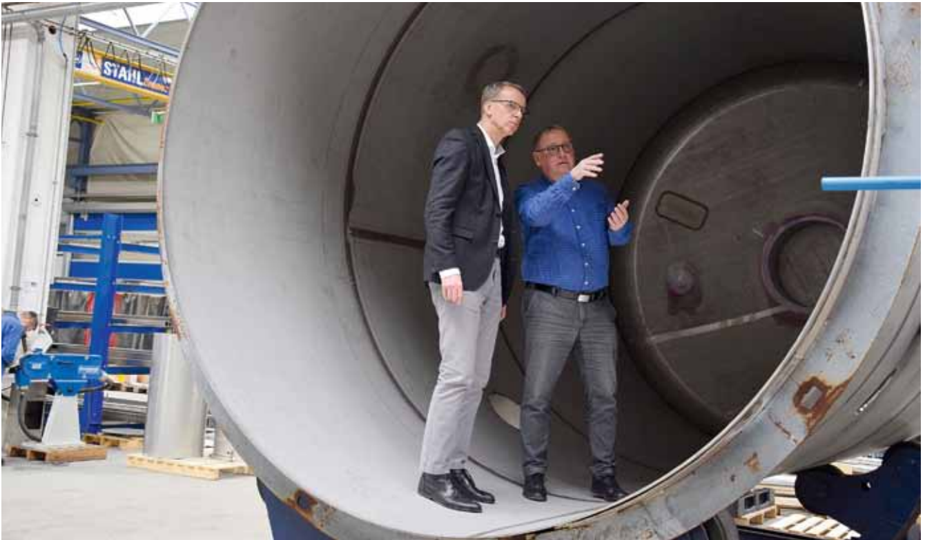
45.000 Liter Fassungsvermögen hat dieser Behälter für einen Hersteller für löslichen Kaffee mit Sitz in Hamburg. Stefan Rudert erläutert IHK-Geschäftsführer Torsten Spranger Konstruktions- und Fertigungsprozesse.
