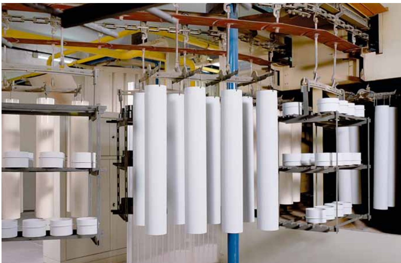
Beschichtete Ofenrohre kurz vor dem Einbrennofen.
