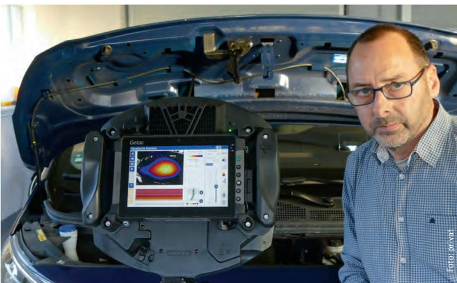
Visualisierung von Geräuschquellen via Messgerät ACAM: Je nach Frequenzbereich werden Schallwellen in Farben dargestellt, sodass Michael Röhler die Quellen nahezu punktgenau lokalisieren kann.
