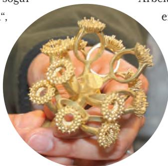
Die ausgegossenen Modelle müssen vor der Weiterverarbeitung nur noch an den Schnittstellen geschliffen werden.
