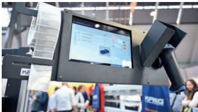
EINE STABILE UMHAUSUNG schützt das Tablet vor Schlägen und Erschütterungen.
