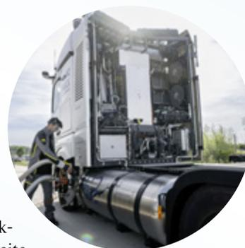
Im Testbetrieb: GenH<sub>2</sub>-Prototypen von Daimler Trucks Wörth
