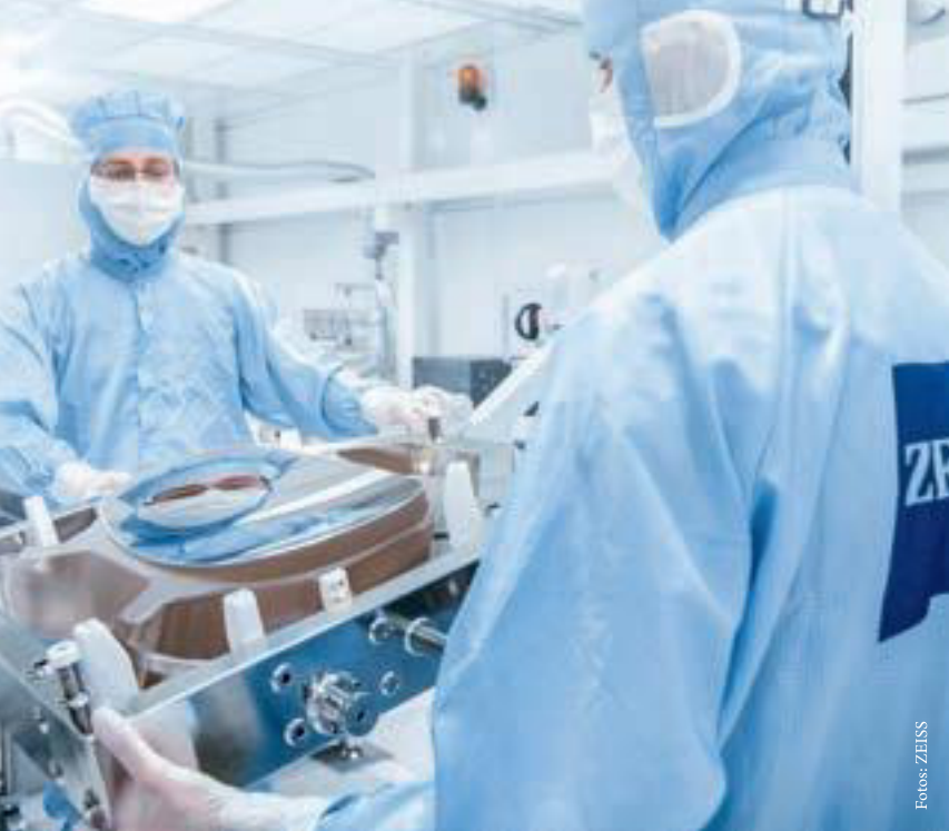
Die präzisesten Spiegel der Welt von ZEISS ermöglichen die EUV-Lithographie.
