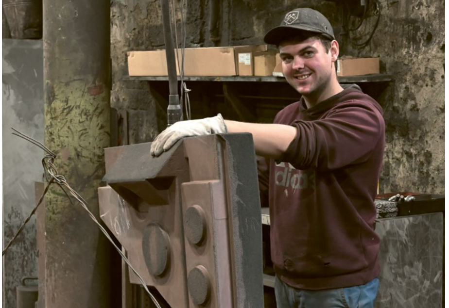
Paul Dams Arbeit erfordert Fingerspitzengefühl. Als Gießereimechaniker fertigt er Formen, die später mit flüssigem Eisen gefüllt werden.
