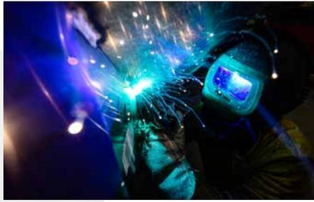
Schweißarbeit auf höchstem Niveau: Jede Naht der Druckbehälter wird durch Röntgen überprüft.
