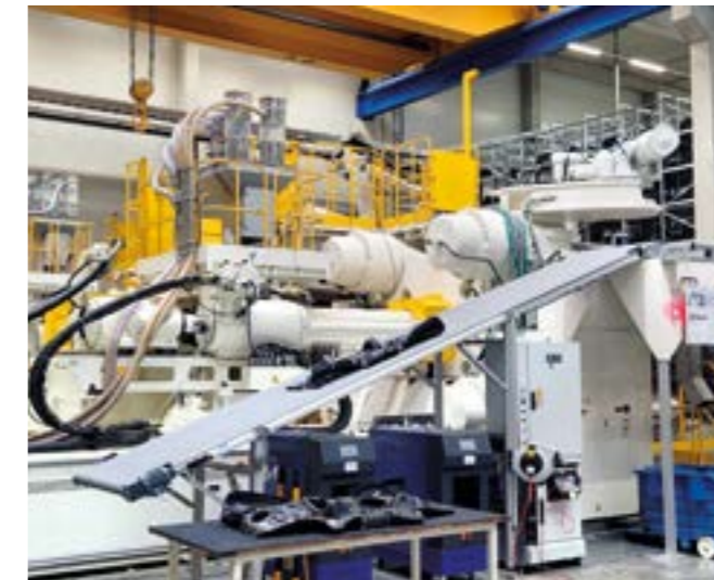
In der neuen Spritzguss- halle in Straubing werden vor allem Teile für die Innenverkleidung von Autos produziert.
