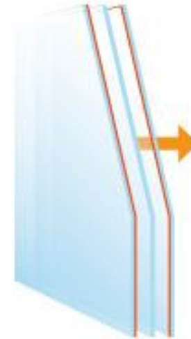
Dreifachverglasung U-Wert von 0,8 bis 0,4 W/qmK
