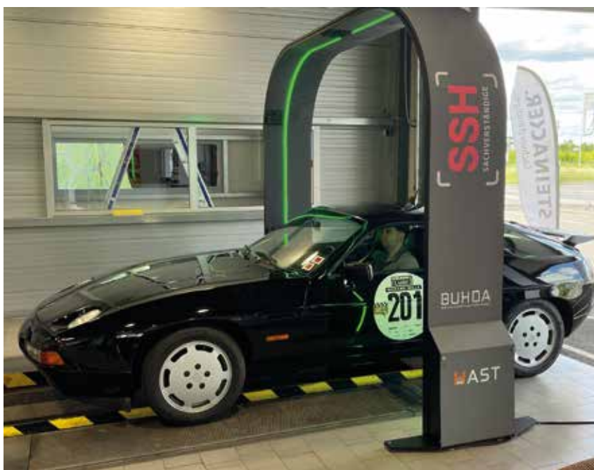
Schnelle Schadenaufnahme: Die Firmengruppe Steinacker vermisst Dellen mit einem Hagelscanner.
