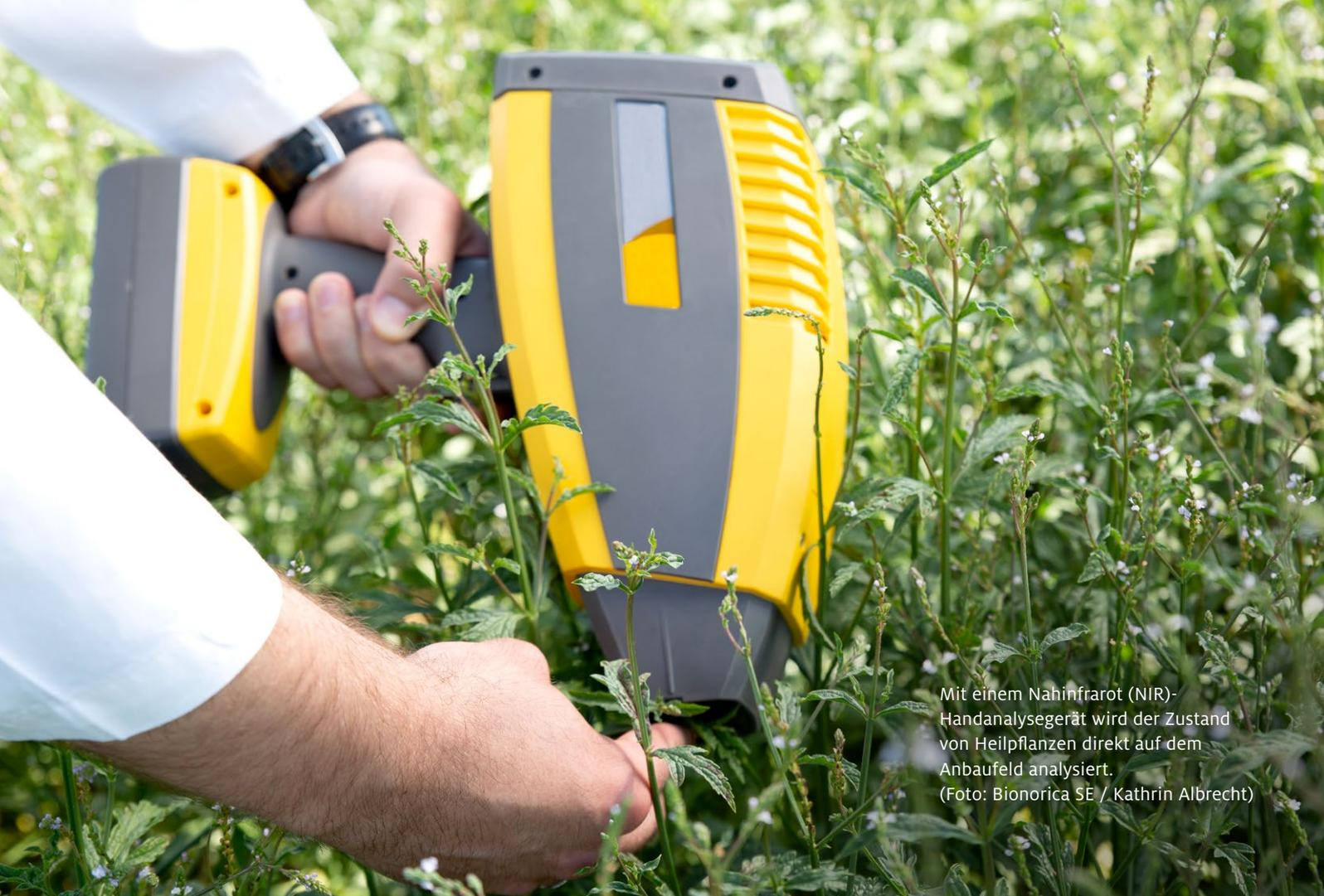
Mit einem Nahinfrarot (NIR)-Handanalysegerät wird der Zustand von Heilpflanzen direkt auf dem Anbaufeld analysiert.
