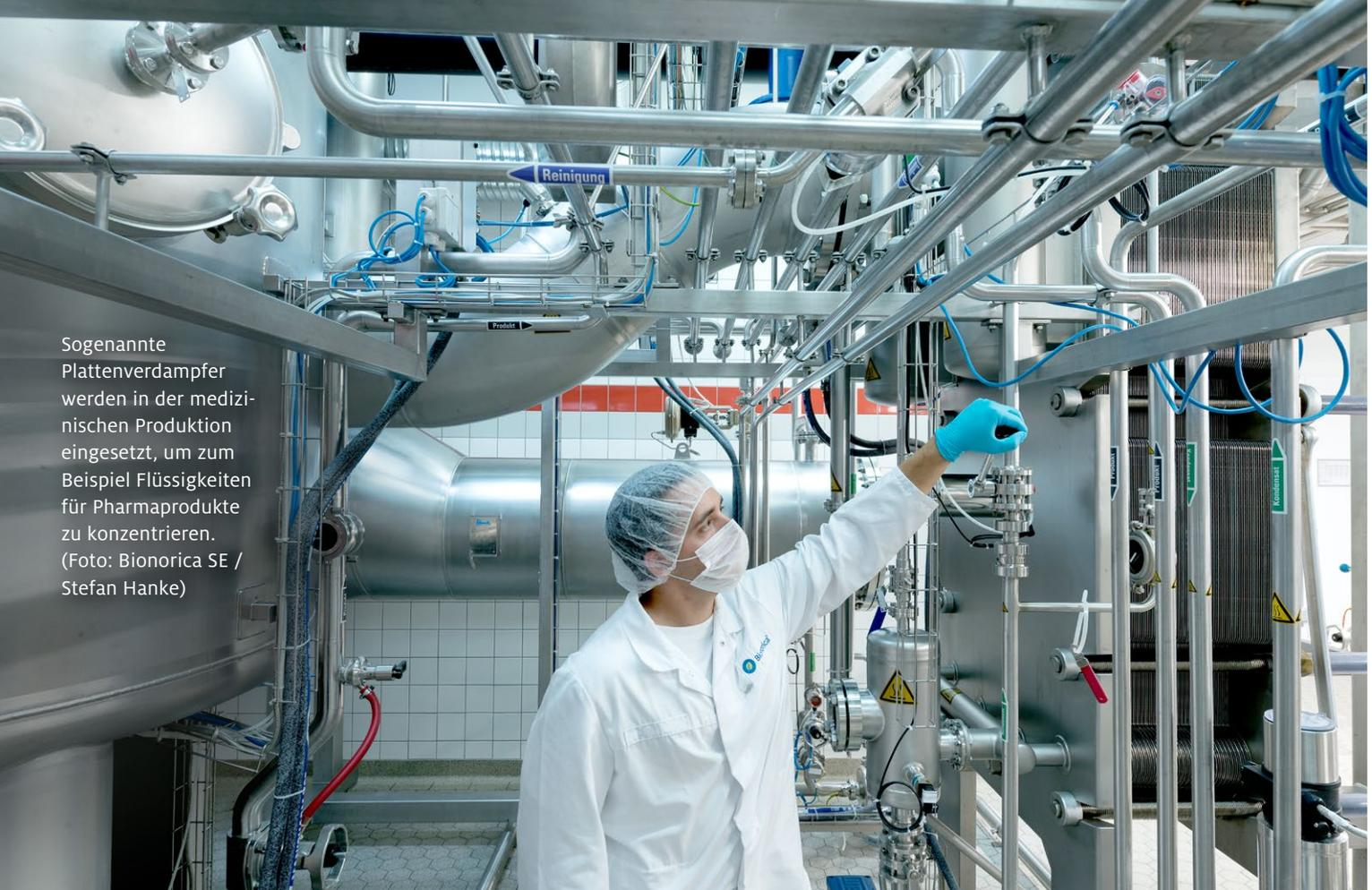
Sogenannte Plattenverdampfer werden in der medizinischen Produktion eingesetzt, um zum Beispiel Flüssigkeiten für Pharmaprodukte zu konzentrieren. (Foto: Bionorica SE / Stefan Hanke)
