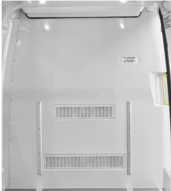
Trennwand im fertigen Fahrzeug, umlaufend versiegelt
