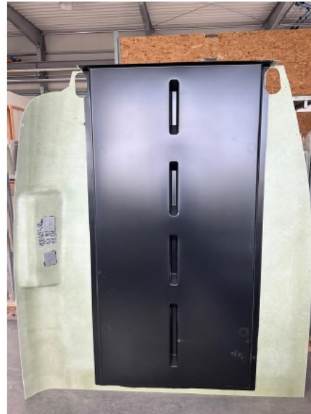
Rückseite der Trennwand mit gasdichtem Luftkanal für die Laderaumklimatisierung
