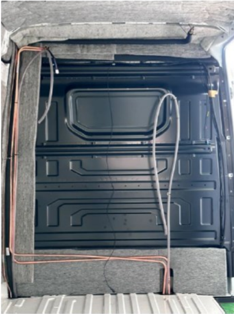
Trennwand im fertigen Fahrzeug, umlaufend versiegelt
