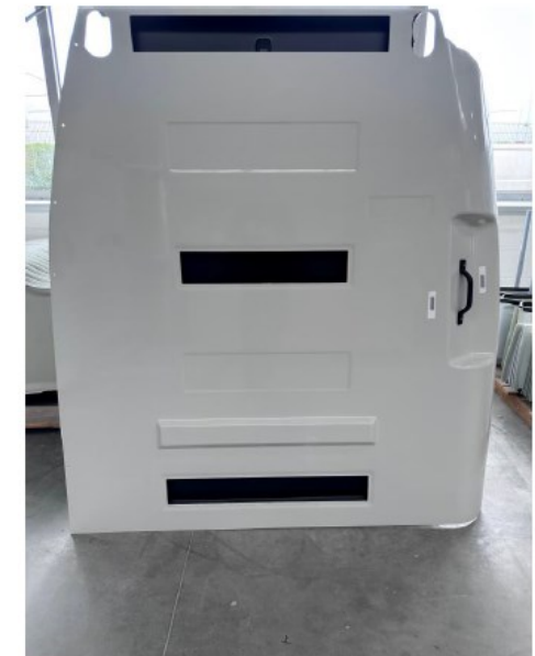
Innenseite der Trennwand aus Sicht des Laderaumes. Bilder zeigen die beiden unteren Ansaugkanäle und den oberen Ausblaskanal
