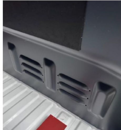
Rückseite der Trennwand mit gasdichtem Luftkanal für die Laderaumklimatisierung
