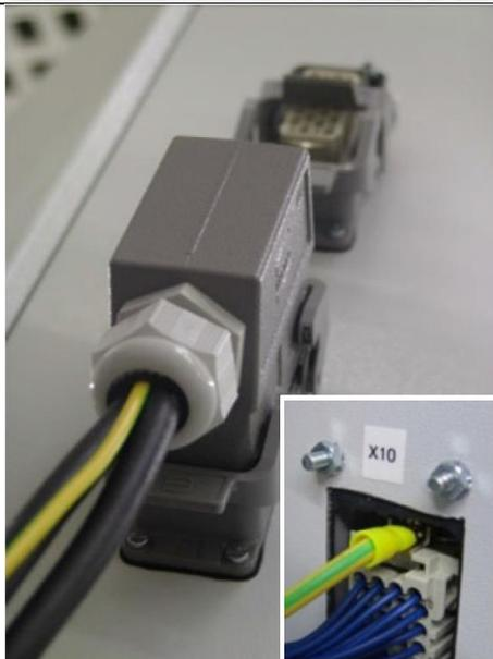
Der Schutzleiteranschluss kann durch den Industriestecker –X10 geführt werden. Die PE Leitung zur mechanischen Baugruppe muss in 6mm<sup>2</sup> ausgeführt sein (mechanische Belastung).
