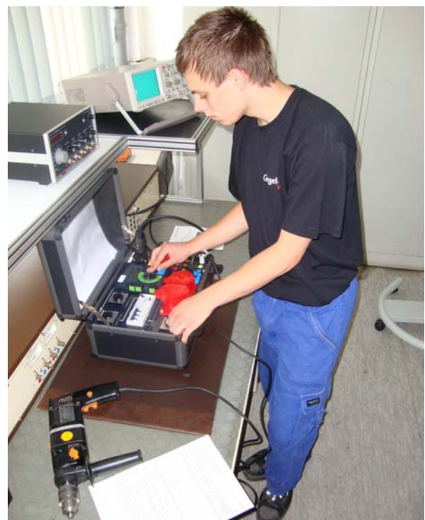
Abb. 2 1) : Wiederholungsprüfung an einem elektr. Gerät
