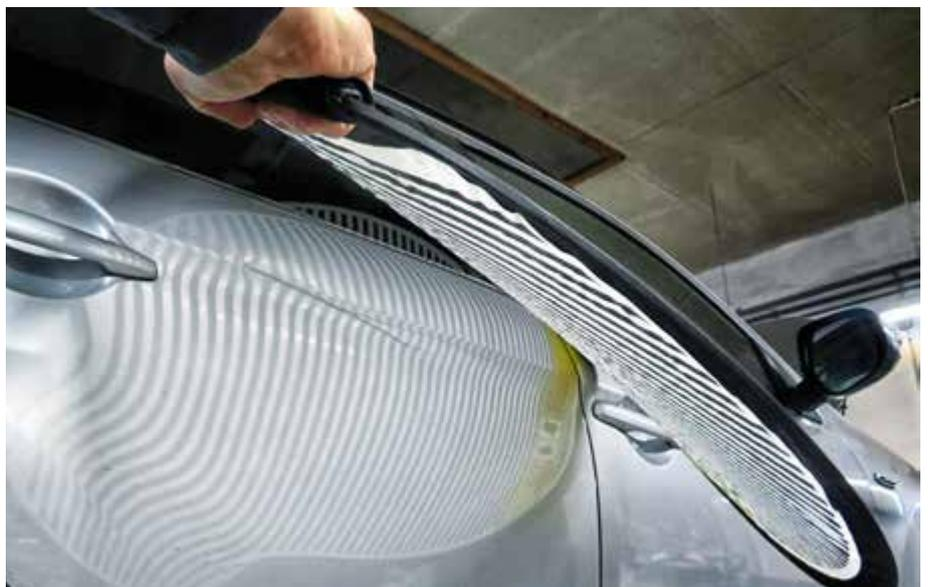
Mit dem »Dellensegel« werden Hagelschäden und andere Verformungen sichtbar.
