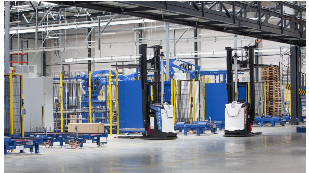
Fahrerlose Transportsysteme in der Blechwarenfabrik
