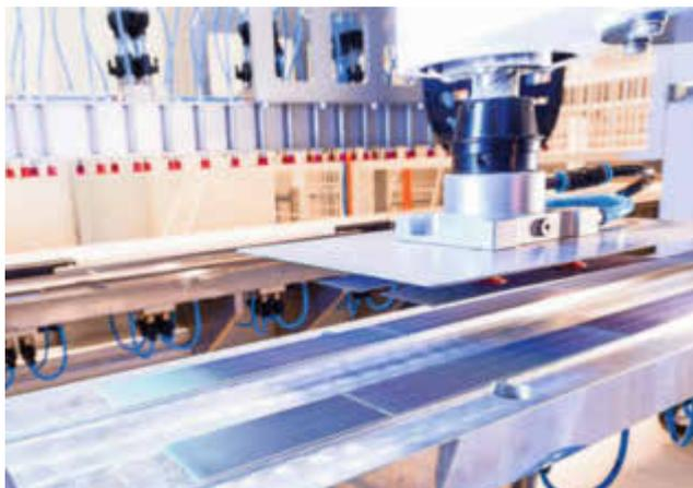
Die M10-Schindel-Matrix-Solarzellen-Verschaltungsanlage, für die das Joint Venture gegründet wurde.
