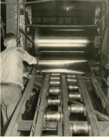
Warmwalzen von Nickelblechen in der Firma Basse & Selve, Werk Linscheid, um 1950
