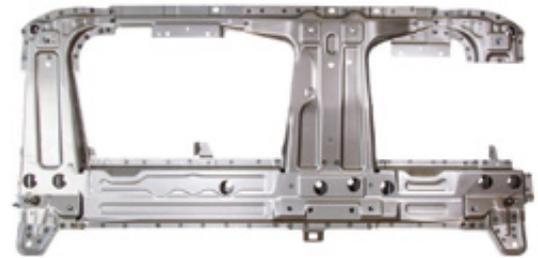
Karosserie-Strukturbauteil für OEM-Kunden / Schweißzellen mit bis zu 10 Robotern
