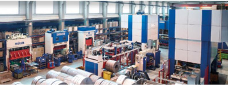
100 Pressen, davon 50 Stanz- und Umformlinien von 100 bis 1.250 Tonnen Presskraft und bis 5 m Tischlänge
