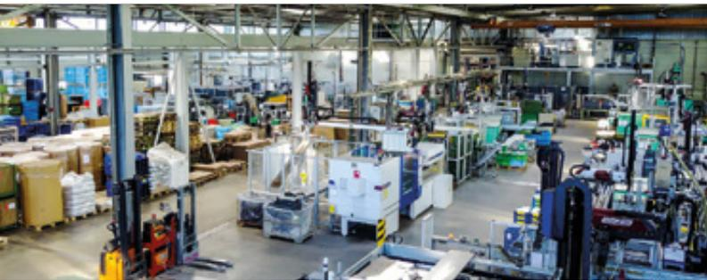
50 Spritzguss-Maschinen (50 - 1.000 Tonnen Schließkraft), z.T. 2K-Technik und integrierte Montage-Roboter z.B. für Hybridbauteile
