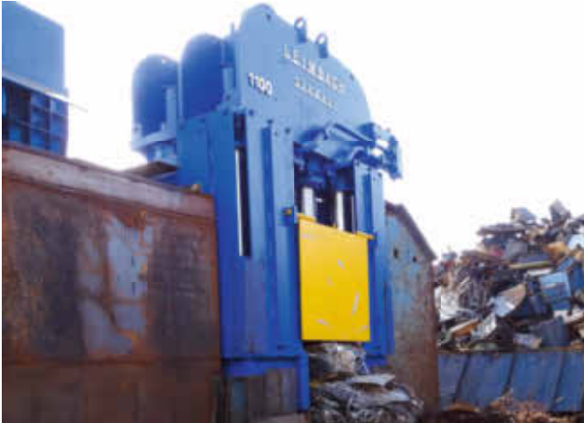
Die Schrottschere von vorne: Hier werden die gepressten Schrottstücke ausgegeben und abgeschnitten.
