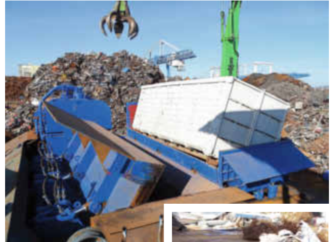
Blick von oben: Ein großer Container wird von oben in die Schrottschere geladen. Viel von ihm bleibt am Ende nicht übrig (rechts).
