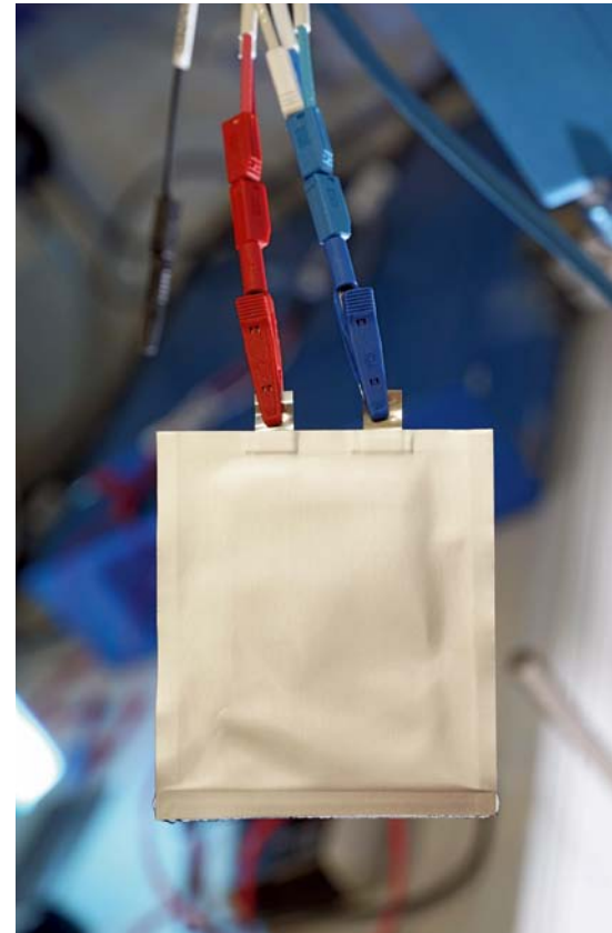
Eine Dünnschichtbatterie im CEEC Jena mit gedruckter polymerbasierter Elektrode.
