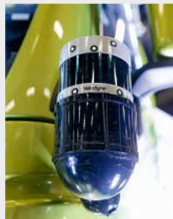
*Ein Laserscanner zur Umgebungserfassung ist unter dem Rückspiegel eines autonom fahrenden Trucks des Projekts „Hamburg Truckpilot“ angebracht. HHLA und MAN Truck bilanzieren auf der Messe nach eineinhalb Jahren ihr gemeinsames Projekt zum automatisierten Containertransport.*
