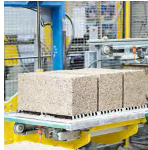
von Hanf e. K.: Die Hanfbausteine werden in Form gepresst und luftgetrocknet.
