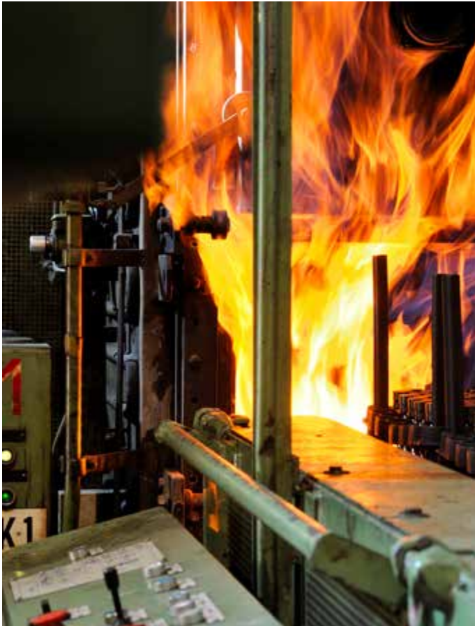
Bauteile aus einem konventionellen Einsatzstahl wie Lenkungsteile aus dem Automobilbau werden beim Einsatzhärten in Mehrzweckkammeröfen bei ca. 880 – 980 °C aufgekocht und anschließend in Öl abgeschreckt.
