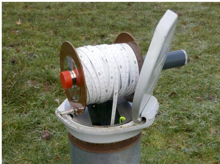
*Abb. 14: Grundwasserstandsmessung (Quelle: LANUV NRW)*
