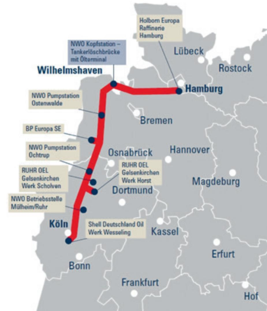
Die **Nord-West Ölleitung**, abgekürzt NWO, wurde im Jahr 1956 gegründet und 1958 in Betrieb genommen. Die NWO versorgt vier Raffinerien von Lingen bis Wesseling. Die Pipeline hat eine Gesamtlänge von 391 km. Der Durchmesser der Pipeline beträgt 71 cm. In der Abbildung 32 ist der Trassenverlauf der NWO erkennbar.
