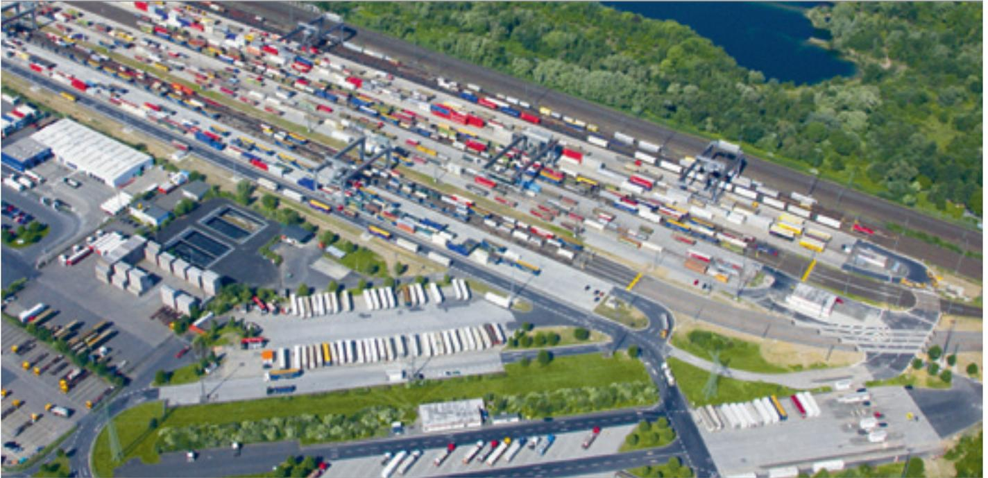
Seit Herbst 2015 ist in Köln-Niehl das Containerterminal Nord der HGK in Betrieb. Zunächst stehen fünf Gleise mit je 300 m Nutzlänge zur Verfügung, die Kapazität der Ausbaustufe 1 beträgt ca. 42.000 Ladeeinheiten pro Jahr. Perspektivisch soll in Ausbaustufe 4 schrittweise eine Umschlagskapazität von bis zu 250.000 Ladeeinheiten pro Jahr erreicht werden. Geplant sind auch Abstellmöglichkeiten zur Pufferung von Containern, auch für Gefahrgut.<sup>140</sup>
