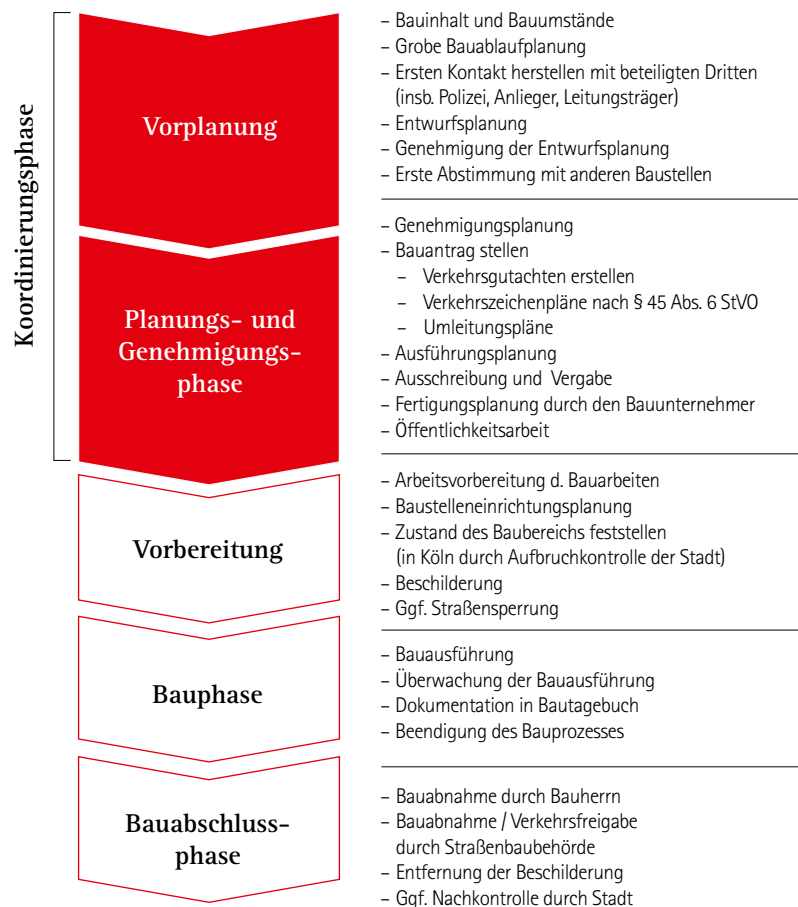
Abbildung 12: Theoretischer Baustellenprozess (eigene Abbildung) 52
