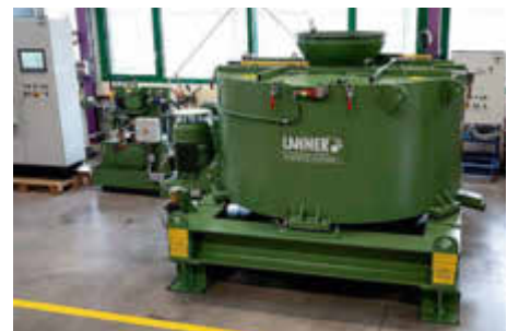
Die neue großvolumige Schubbodenzentrifuge von Lanner Anlagenbau.
