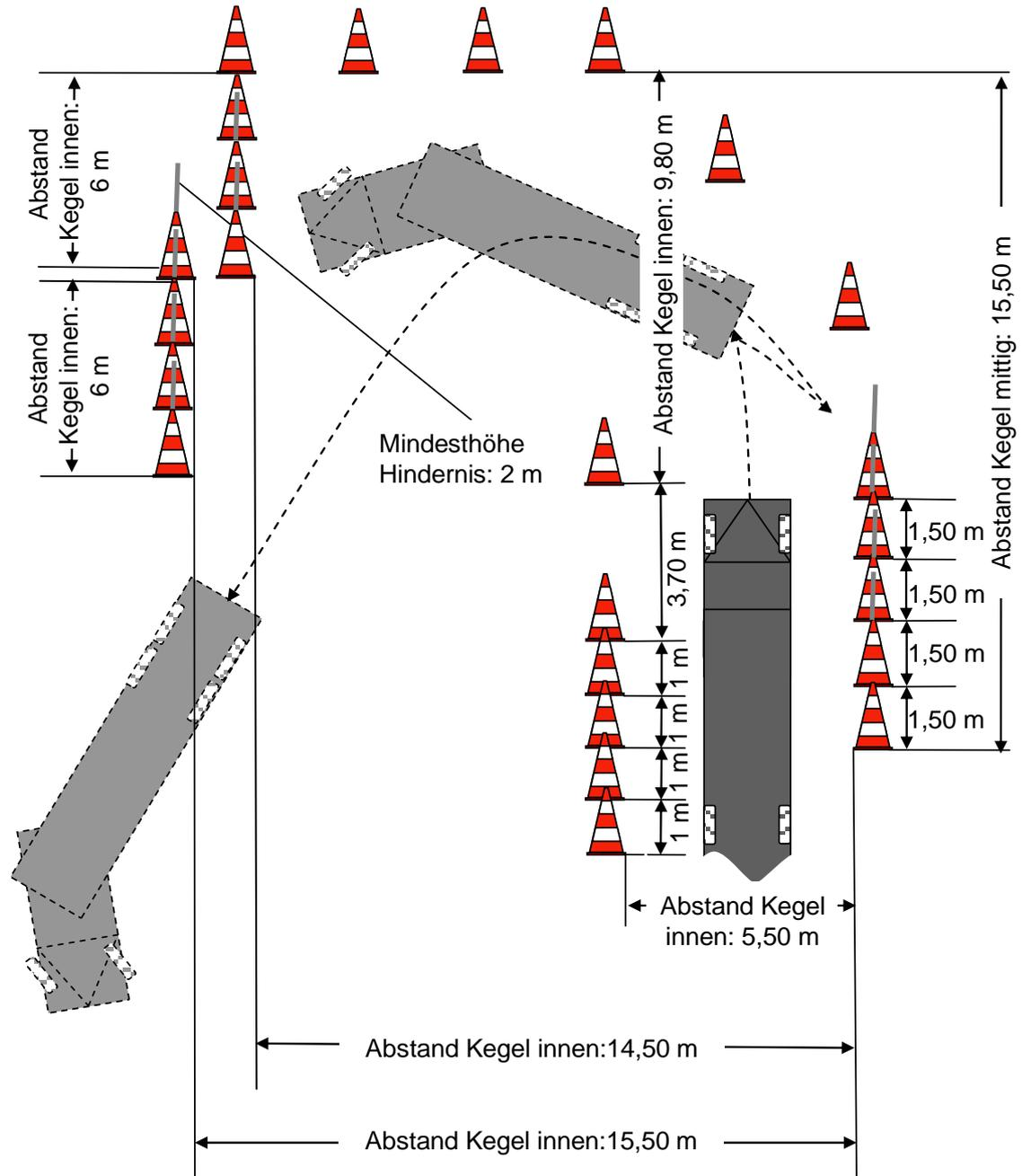
Bewertung: Bewertet wird die fahrtechnische Lösung nach dem Abbiegen um 90 Grad bis zur Möglichkeit zu wenden/das Hindernis zu umfahren. Ein sicheres und wirtschaftliches Fahren bei guter Fahrraumeinteilung wird mit 10 Punkten bewertet.
