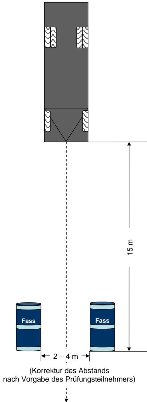
Bewertung: Maßgrundlage ist das lichte Maß zwischen den beiden Fässern an der engsten Stelle. Gemessen wird am Fahrzeug einschließlich der Spuraltelemente (Breite über alles, einschließlich Spuralte- bzw. Umrissleuchten, jedoch ohne Spiegel). Der Messbereich des Fahrzeugs darf die Fasshöhe nicht überschreiten.
