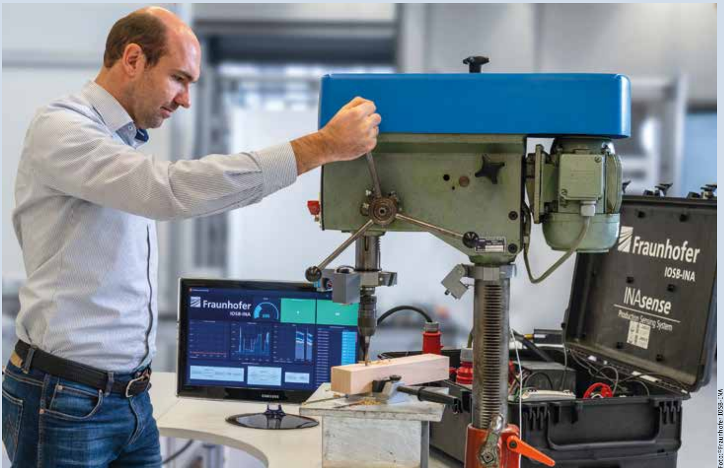
Mit dem „Messkoffer“ INAsense werden Daten an den Maschinen erfasst
