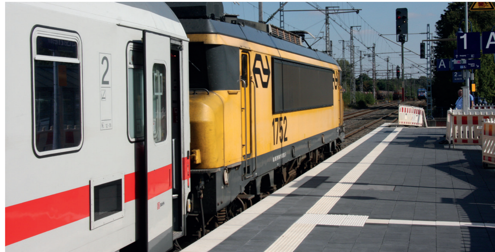
Lokwechsel in Bad Bentheim: Die niederländische Lok muss abkoppeln, damit die deutsche Lok (im Hintergrund) die Weiterfahrt im deutschen Bahnstromnetz übernehmen kann.
