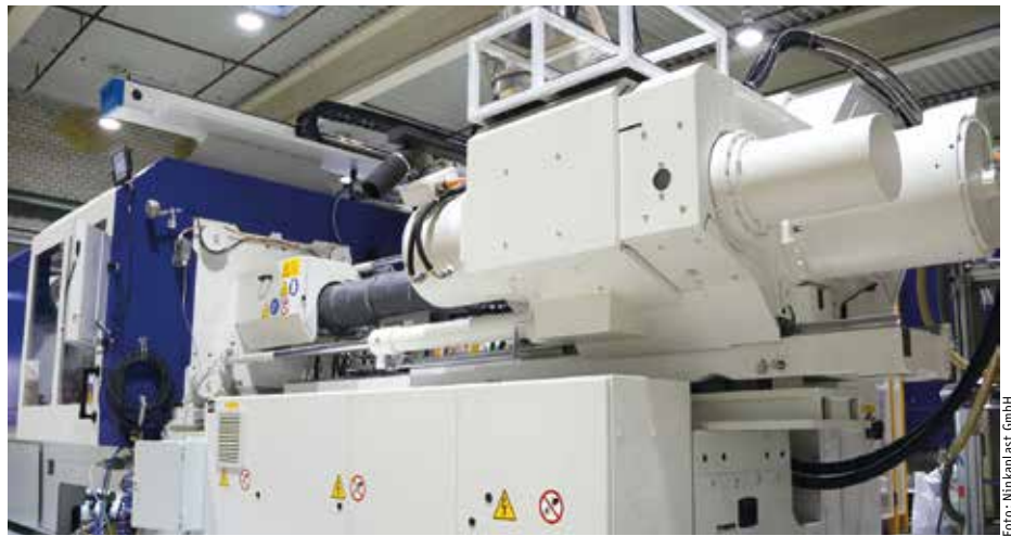
Eine der neuen energieeffizienten „Blue Power“ Spritzgussmaschinen
