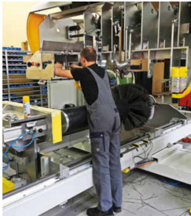
Aufbau einer Ebser-Maschine zur Produktion von Walzenbürsten.
