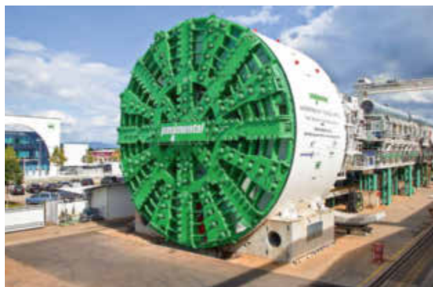
Der größte Tunnelbohrer Europas misst fast 16 Meter im Durchmesser. Auf dem Bild liegt der Gigant noch im Herrenknecht-Werk in Schwanbau. Im Juni schloss er seine Vortriebsmission für einen Straßentunnel der italienischen Autostrada A1. ab
