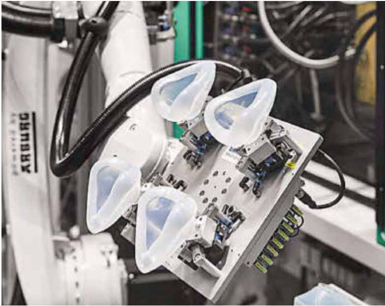
Pro Zyklus entstehen vier Maskenteile, die von einem Sechs-Achs-Roboter entnommen werden. Pro Tag können rund 3.500 Hightech-Masken produziert werden.
