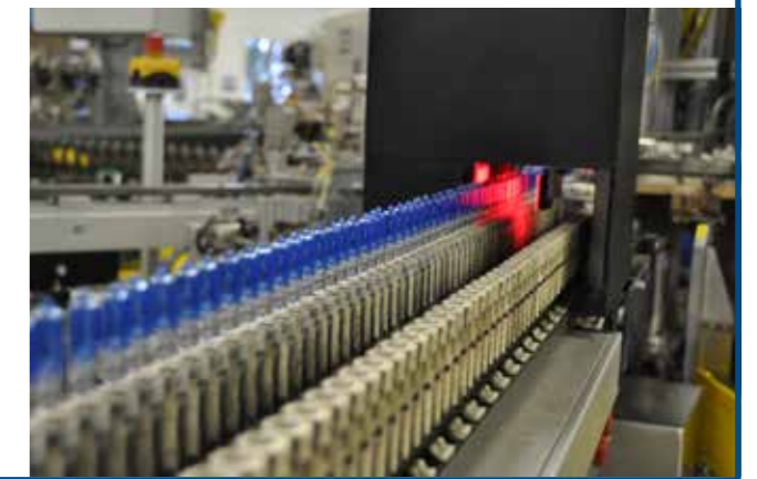
Voll automatisierte Halogenlampenfertigung, Foto: unico - Agentur für Gestaltung
