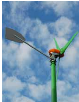
Heywind 3,5 Bernburg nah: Heywind 3,5 kW in Bernburg, Masthöhe 12m, Baujahr 2011
