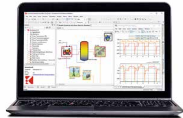
Simulationsmodell eines kombinierten Strom- und Wärmeversorgungssystems für ein Wohnquartier
