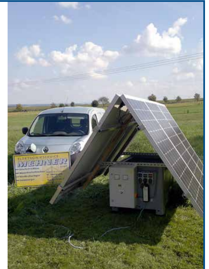
Strominsel mit angeschlossenem Elektroauto Renault Kangoo ZE
