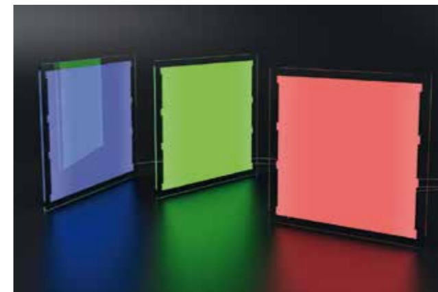
OLED's - im Vakuum aufgedampfte organische Moleküle / © FHR Anlagenbau GmbH
