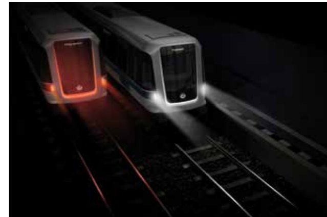
Außenlicht C30 - Metro Stockholm: Dekolicht, Logolicht und Scheinwerfer, © Bombardier
