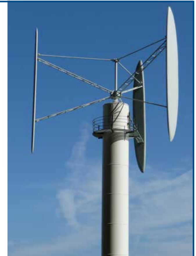
vertikalachsige Kleinwindanlage H75
