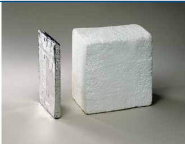
Stärke Vakuum-Isolationspaneele im Vergleich zu herkömmlicher Polystyrol-Dämmung bei gleicher Dämmwirkung
