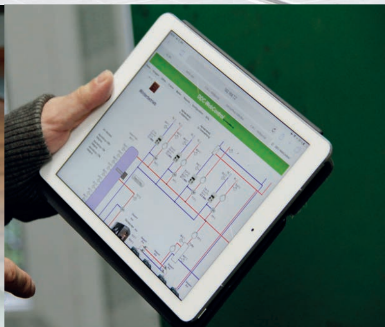
84 Zentrale Überwachung und Steuerung der Heizung
