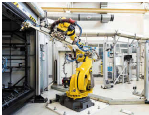
Blick in die Produktion von PWO in Oberkirch: Handlingsroboter einer Montagelinie bei der Entnahme eines Instrumententafelträgers aus der Lasermesszelle.
