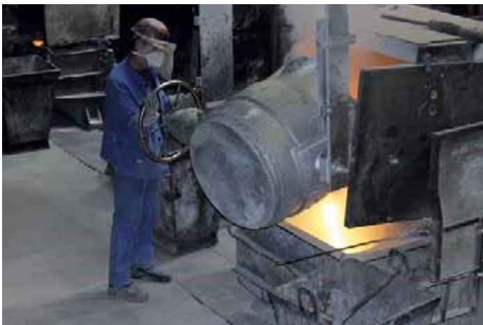
Werner Modder befüllt eine Stranggussanlage des Papenburger Unternehmens.
