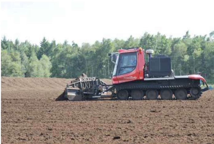
Mit einer Pistenraupe tragen die Torfunternehmer eine dünne Schicht Torf ab.
