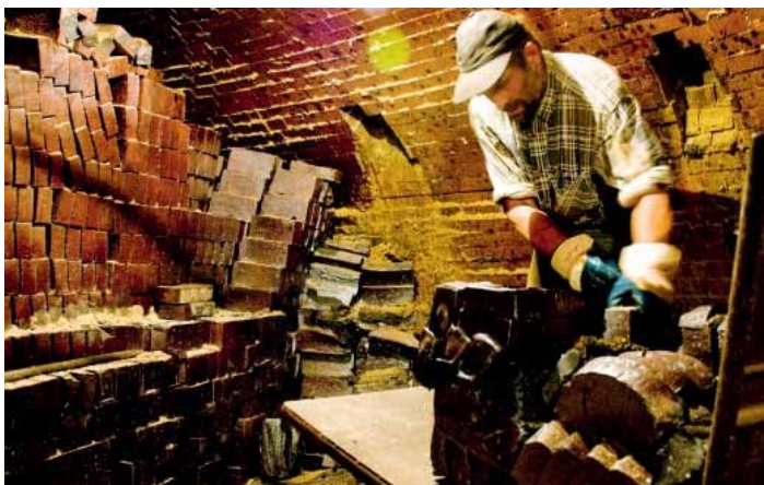
Bei rund 1200 Grad Celsius werden die Steine im Ringofen gebrannt. Danach werden sie auf Karren herausgefahren. Foto: IHK
