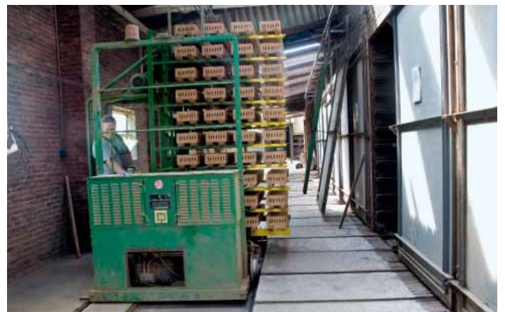
In Trockenkammern werden die Rohlinge fünf bis sieben Tage gelagert. Erst dann sind sie bereit für den Brennvorgang im Ofen. Foto: IHK
