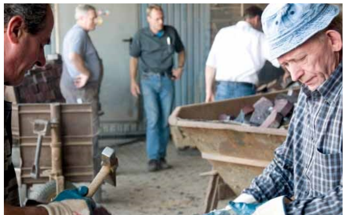
Nach dem Brennen im Ofen sortieren Arbeiter die fertigen Klinker nach Farbe und Struktur. Foto: IHK
