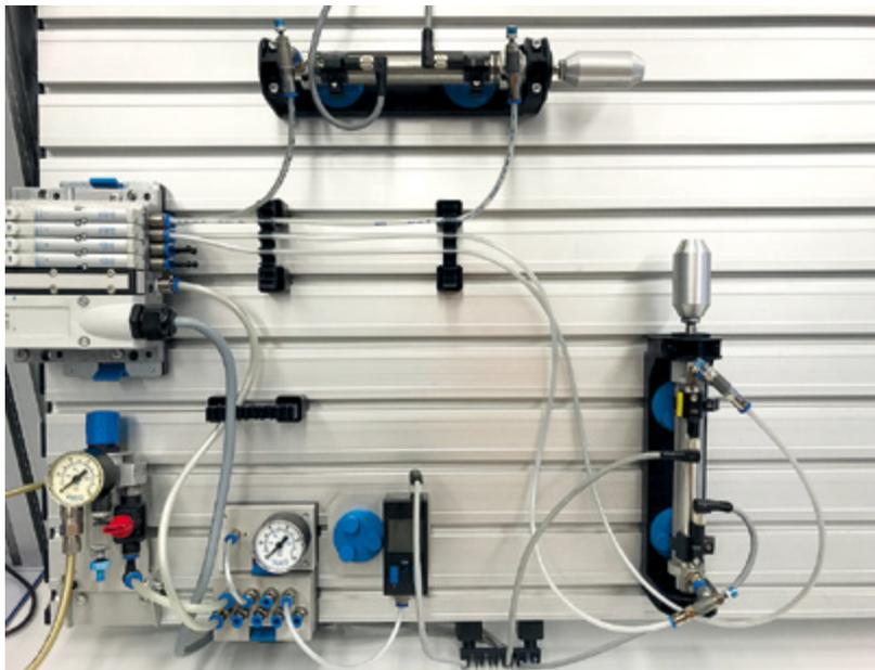
Pneumatik-Aufbau zur Aufgabenstellung „Karton nach oben und dann nach rechts verschieben“
