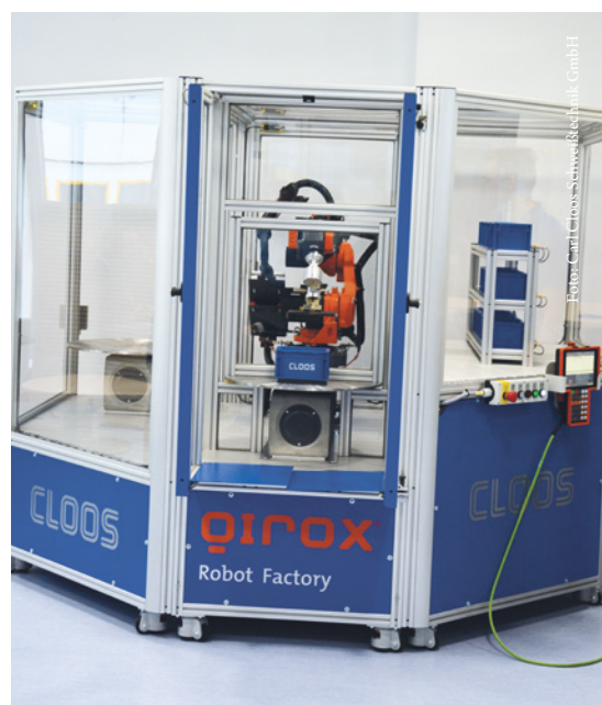
Die QIROX Robot Factory besteht aus verschiedenen Modulen, die individuell zusammengestellt werden können.
