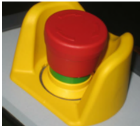
Abb. 2 NOT-HALT-Befehlsgerät mit Schutz vor unbeabsichtigter Betätigung oder vor Beschädigungen
