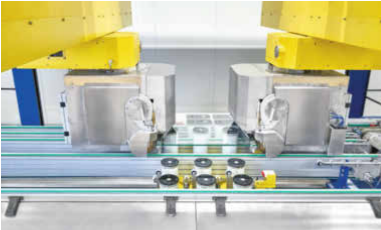
Produktion bei Schafheutle Glassolutions in Freiburg: ein Schleifaggregat mit Topscheiben.
