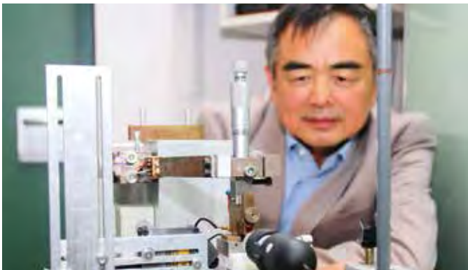
Professor Jian Song kontrolliert die Simulation von Mikrobewegungen, die die Steckverbinder durchlaufen müssen
